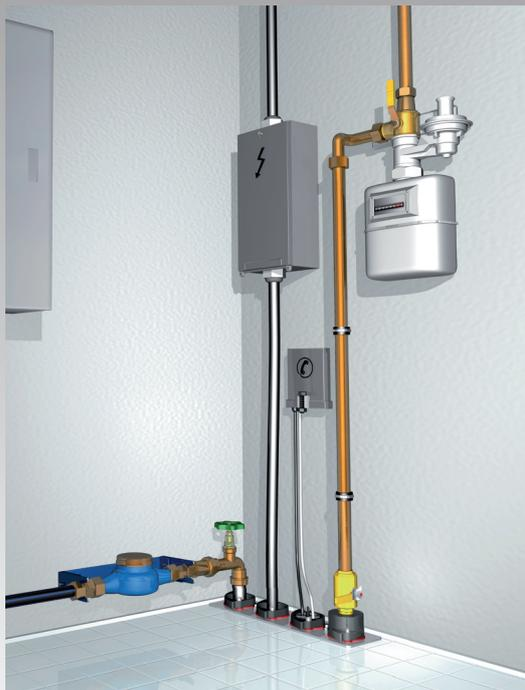
Um ein Optimum an Sicherheit zu gewährleisten, schützen die Stadtwerke Zittau GmbH durch den dauerhaft dichten und platzsparenden Einbau von Mehrspartenhauseinführungen, seit September 2018 ihre Kunden vor Gas- bzw. Wassereintritt von außen.
