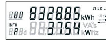
In der unteren Zeile wird die momentane Wirkleistung in W angezeigt.
